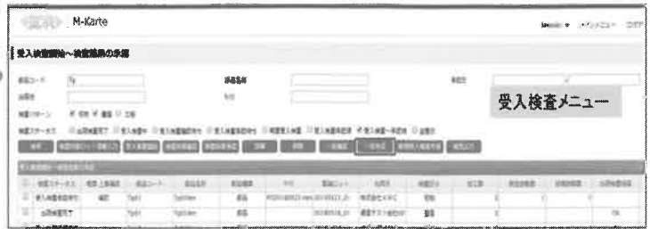
第2図 事務機器メーカーとの樹脂成形部品、プレス部品のデジタル検査システムと“受入検査レス”システム事例
