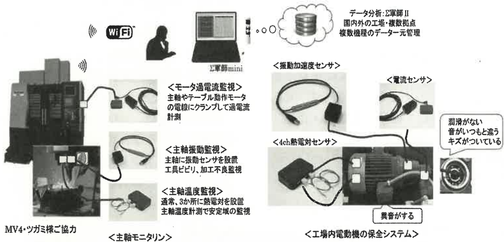
第3図 工作機械の設備・工具異常検知・保全システム「主軸モニタリン」と工場内電動機の保全システムへの無線センサの適用
