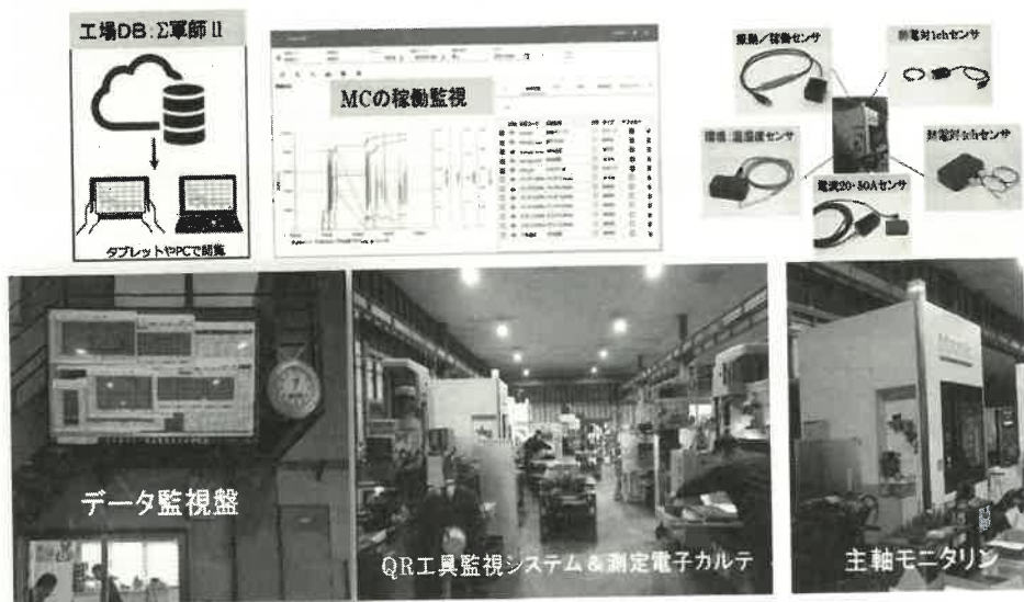
第6図 東興機販(株)のSmart FACTORY: 主軸モニタリン・Σ軍師 II による加工異常検知と設備状態のデータ監視盤
