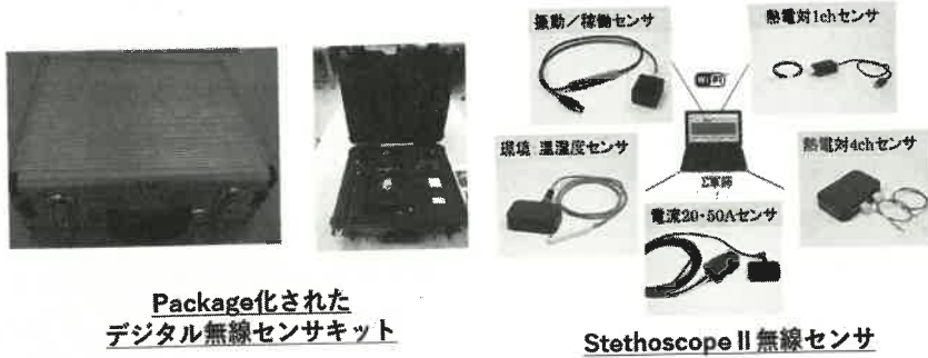
第5図 デジタル保全の時代：保全員が携行し設備異常を検知「デジタル検査キット」
