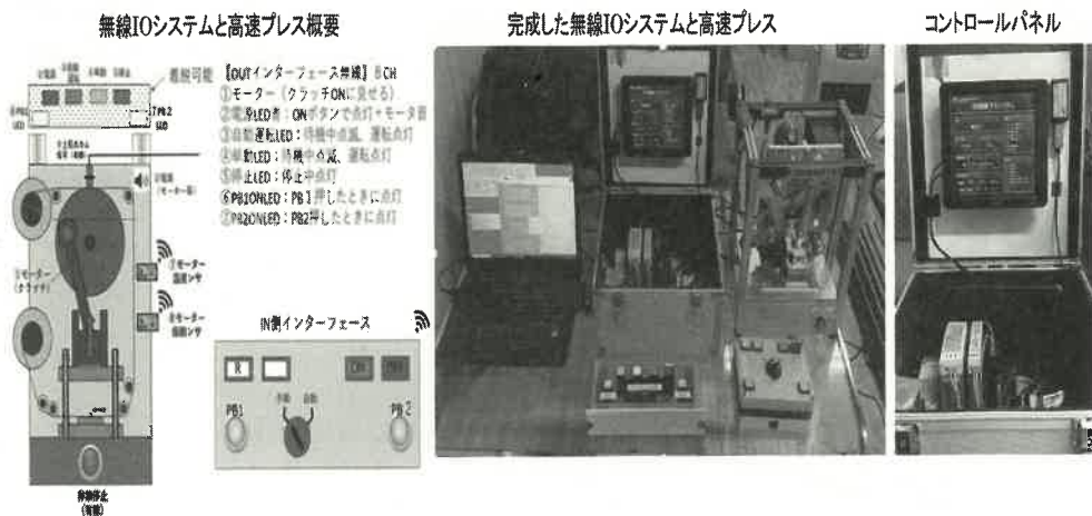
第9図 高速精密プレスと無線I/O「Wireless IO As1 」システム
