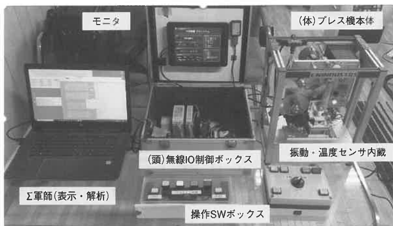
図6 世界初ワイヤレス無線I/Oシステム「Wireless IO As1 」を搭載した次世代プレス機
